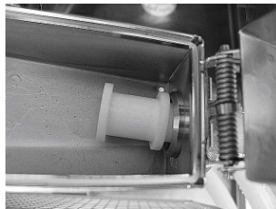
Bild 2: Spezialdorn verengt den Druckkastenablauf
